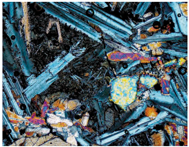
Dünnschliffaufnahme des Alkalibasalts (wie links) mit gekreuzten Polarisatoren. Bildbreite 1,4 mm.
